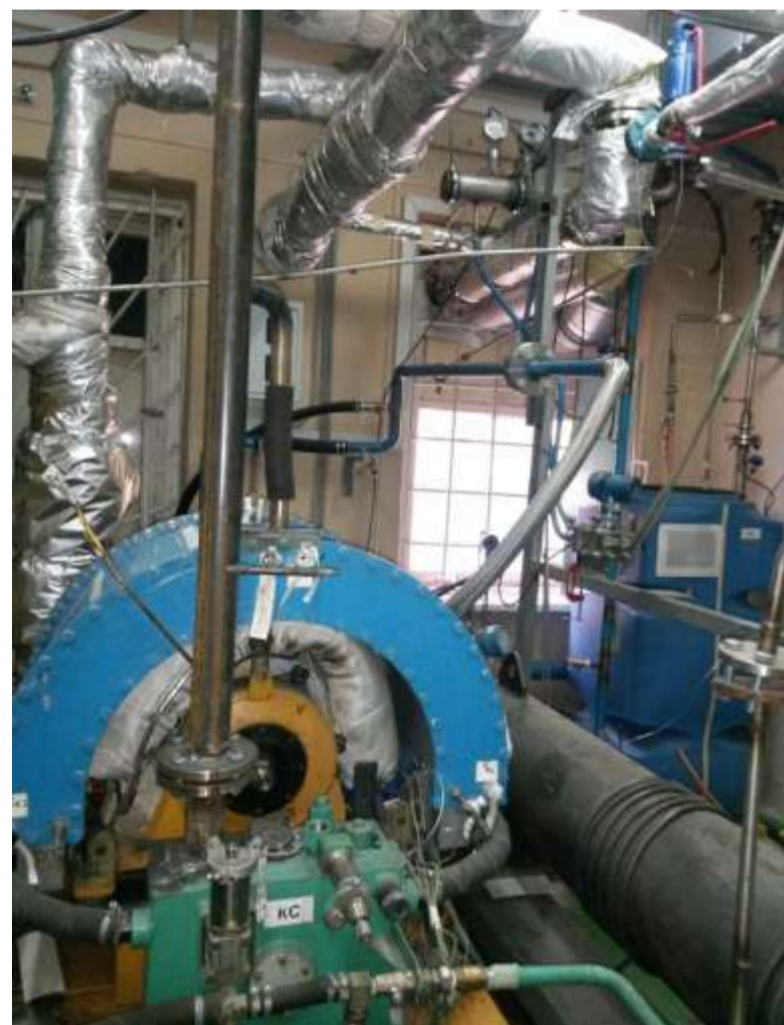
Стенд ВПТУ для экспериментальных исследований работы турбины на парогазовой смеси, с большим (до 15-20%) содержанием неконденсирующихся газов
