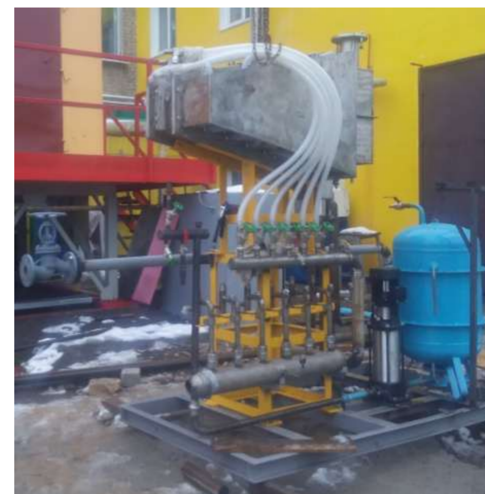
Стенд для экспериментальных исследований экспериментального образца высокоэффективного конденсатора пара с большим (до 15-20%) содержанием неконденсирующихся газов
