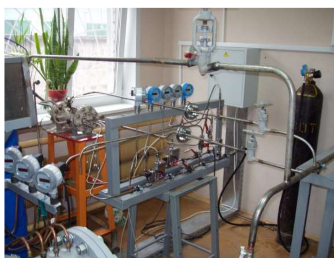
Стенд для экспериментальных исследований экспериментального образца камеры сгорания \text{CH}_4\text{-O}_2 в смеси с водяным паром
