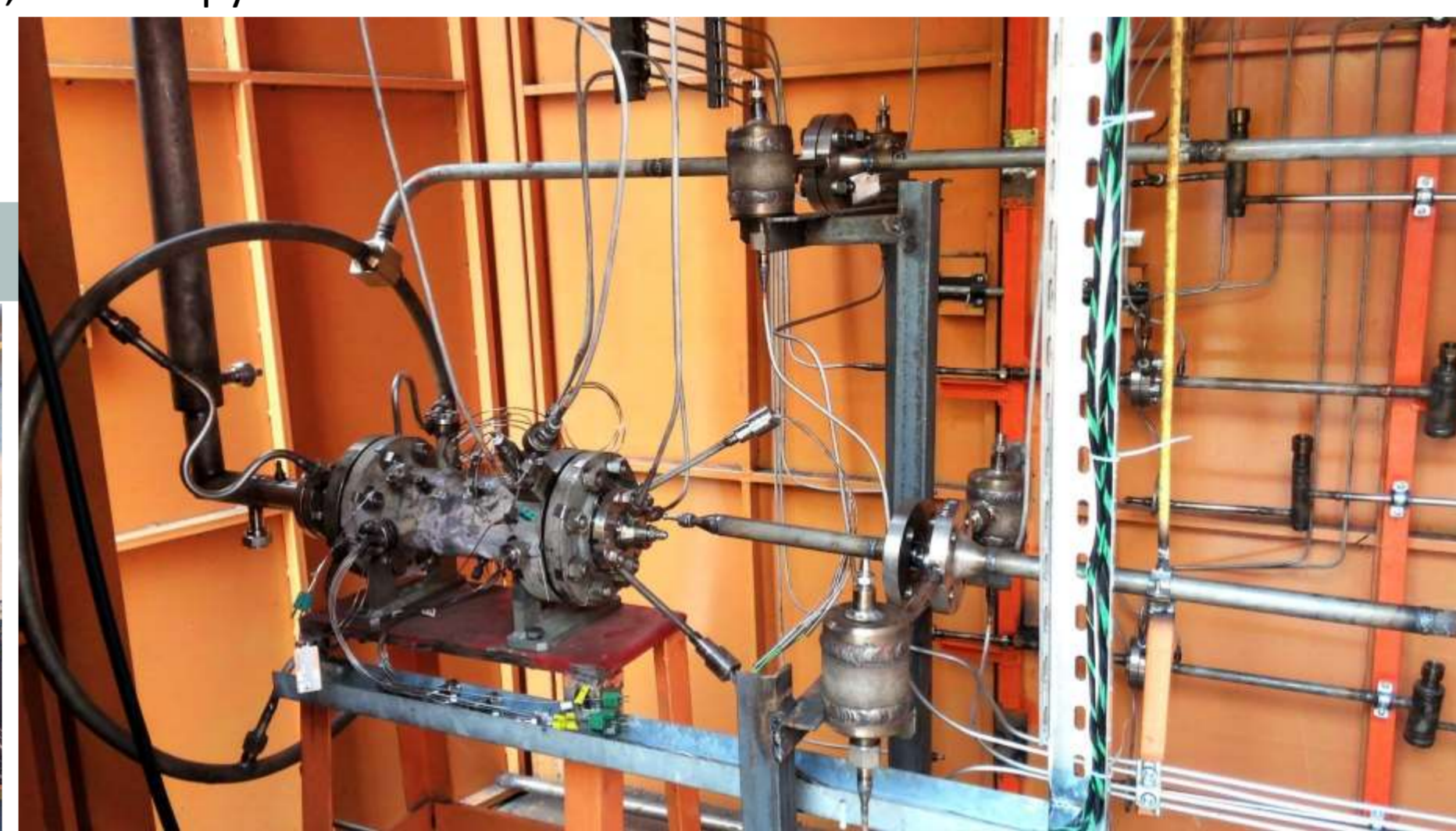
Экспериментальный образец камеры сгорания CH 4 -O 2 в смеси с водяным паром на стенде
