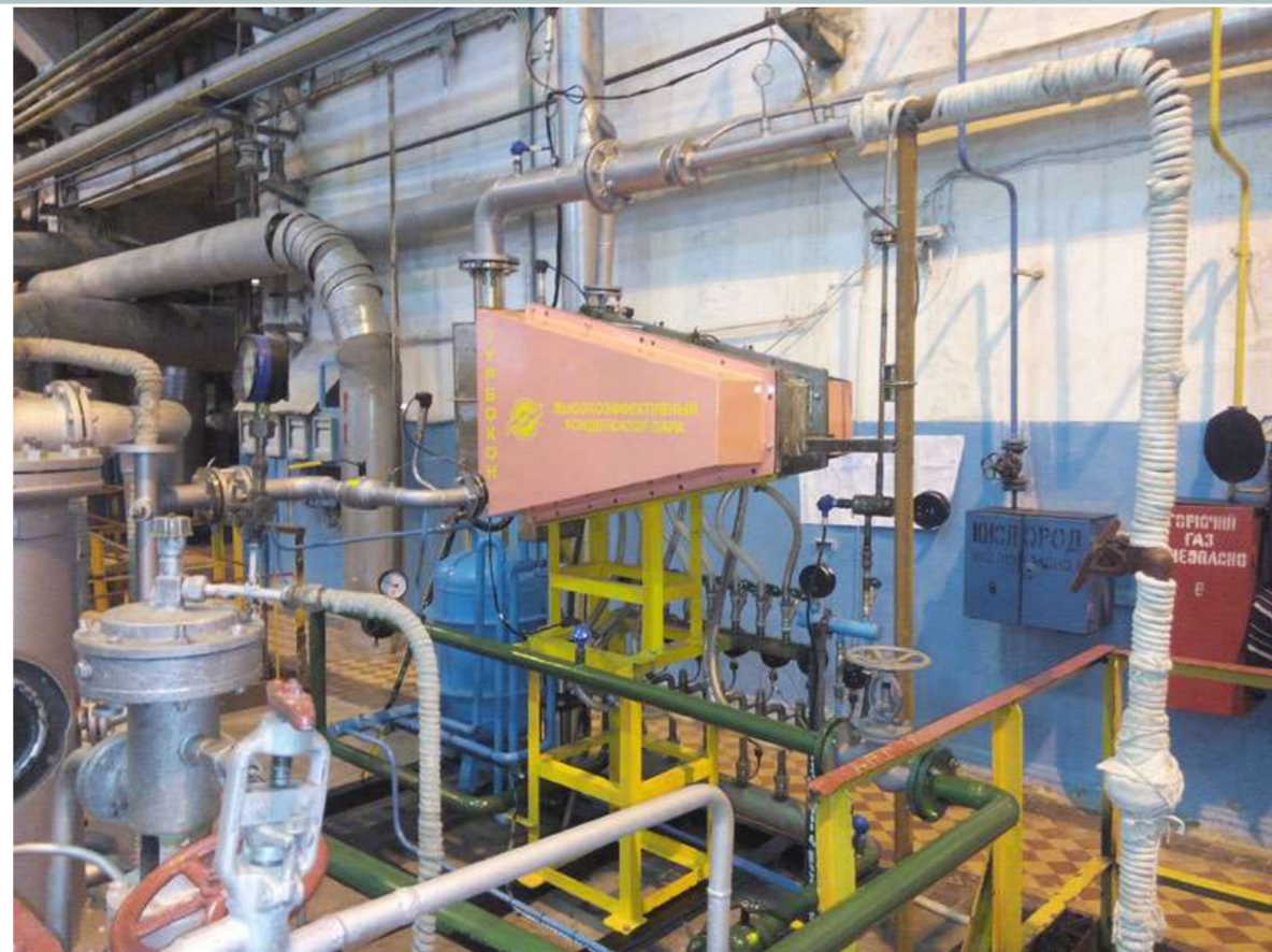
Экспериментальный образец высокоэффективного конденсатора пара с большим (до 15-20%) содержанием неконденсирующихся газов на стенде
