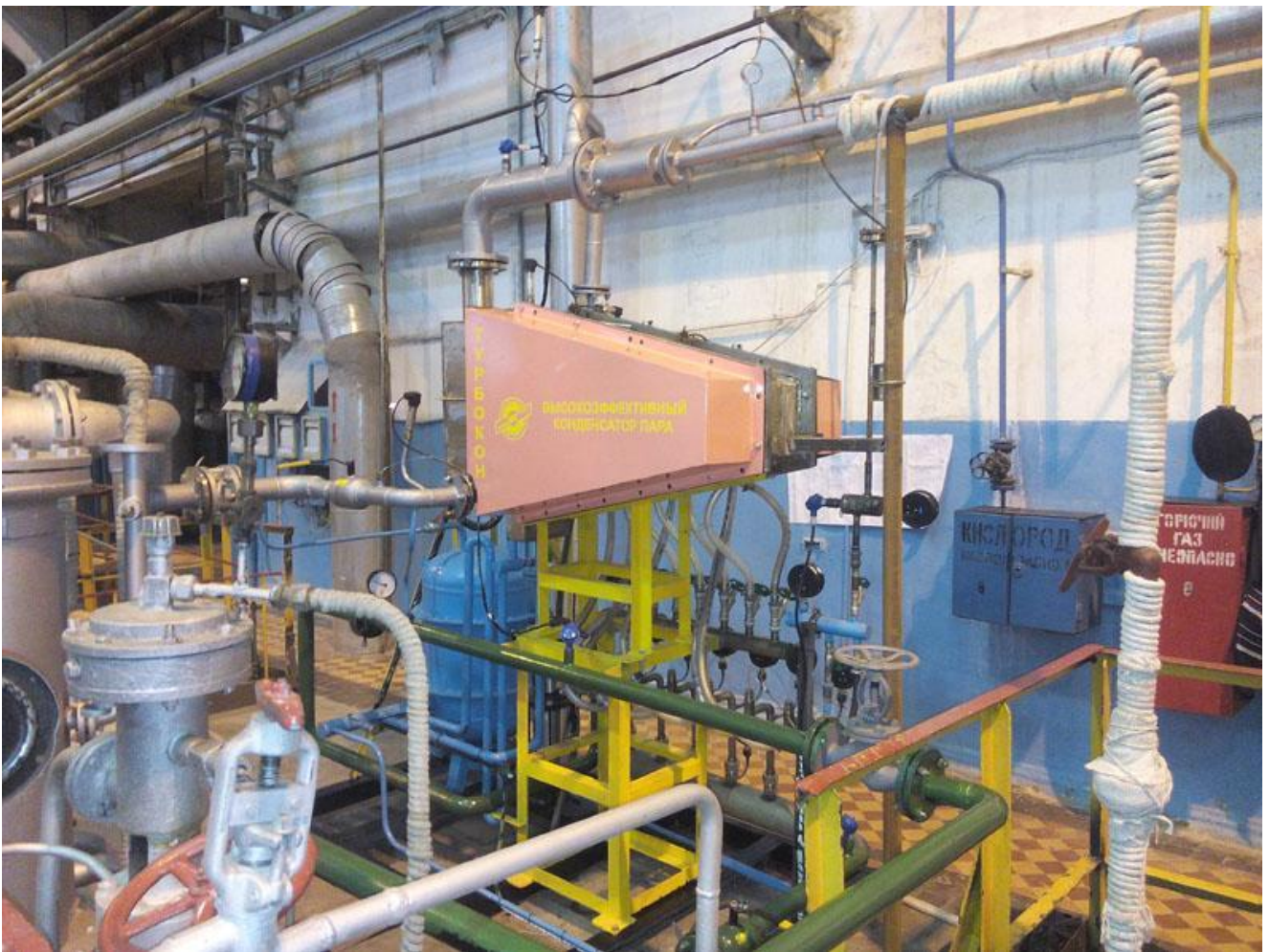
Рис. 1 - Экспериментальный образец высокоэффективного конденсатора пара с большим (до 15-20%) содержанием неконденсирующихся газов на стенде
