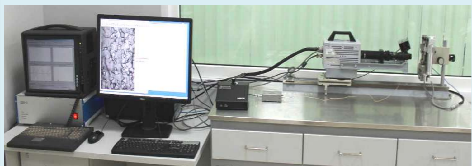
Уникальный испытательный комплекс для проведения исследований деформационного поведения материалов in-situ
