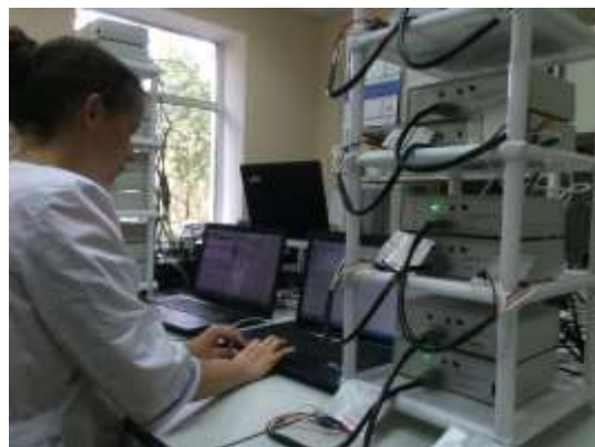
Процесс циклирования аккумуляторов
