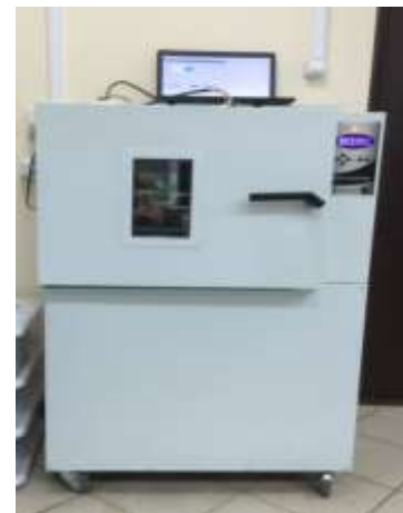
Проведение испытаний аккумуляторов в климатической камере
