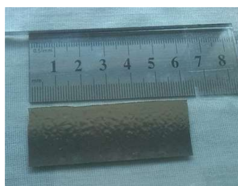
Рисунок 6 - Фольга никеля-63 (толщина 1,5 мкм)
